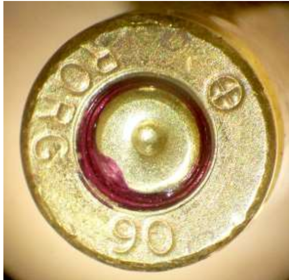
Pic 02 Fired primer before test
